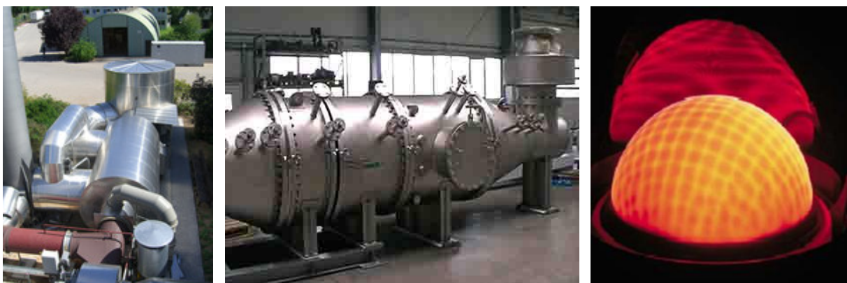
Abbildung 4: Abbildungen zweier Anlagen zur katalytischen Oxidation von brennbaren Gasen, Ansicht des katalytisch wirksamen Matrix-Brenners im Betrieb (Quelle: Dürr Clean Technology Systems AG, R.Scheuchl GmbH, Viessmann GmbH & Co. KG)
