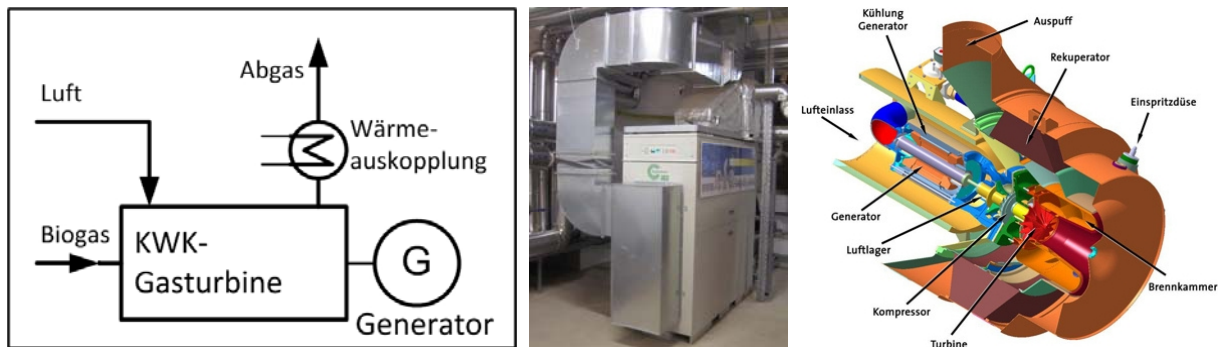
Abbildung 2: Fließbild einer Gasturbine zur kombinierten Produktion von elektrischem Strom und Wärme; Abbildung einer Capstone®-Mikrogasturbinenanlage sowie Schnittzeichnung einer Capstone®-Mikrogasturbine (Quelle: efa Leipzig GmbH, Capstone Turbine Corporation)
